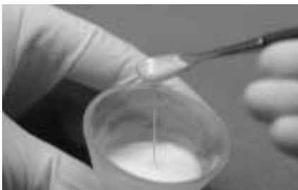
Die noch flüssige Masse in den Schlüssel einfließen lassen
